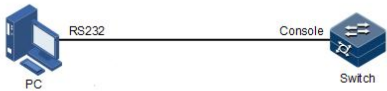
图 1-1 通过 PC 连接 Console 口登录设备的组网示意图
